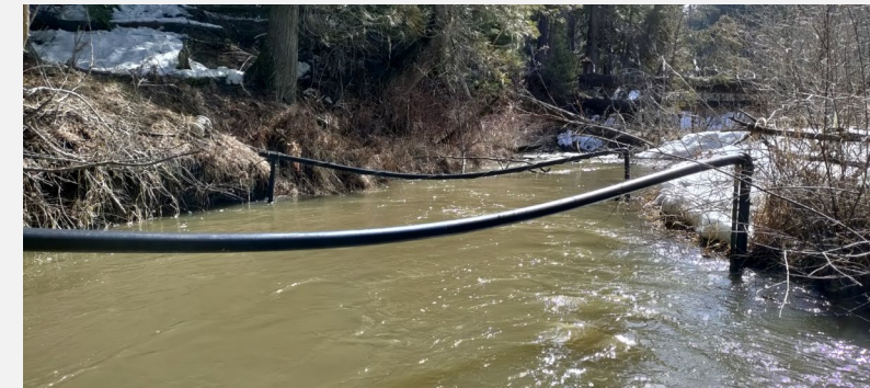
PIT-tag array antennas
